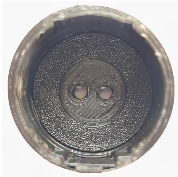
Hinweis: Falls der Magnet nicht direkt in die Aussparung passt, einfach mit leichtem Druck z.B. mit der Rückseite eines Stiftes nachhelfen.
